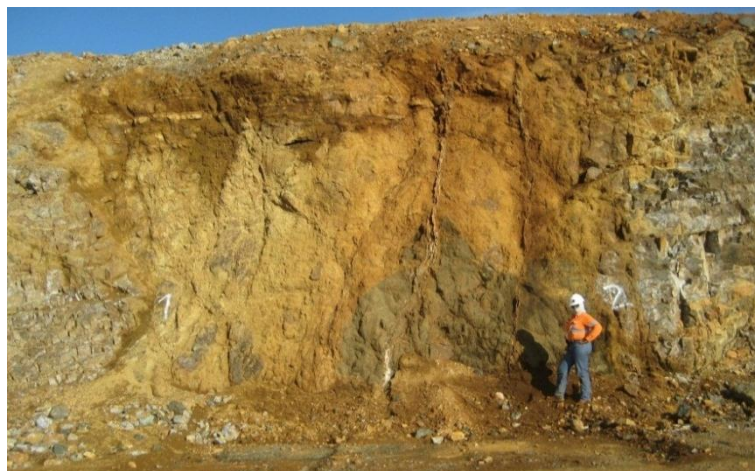
Figura 39. Definición de paquetes por litología (1-2), identificables visualmente y mayores a 5 m (por la escala.) Marcar los puntos en el banco, tomar coordenadas y registrarlos en el formato correspondiente.
