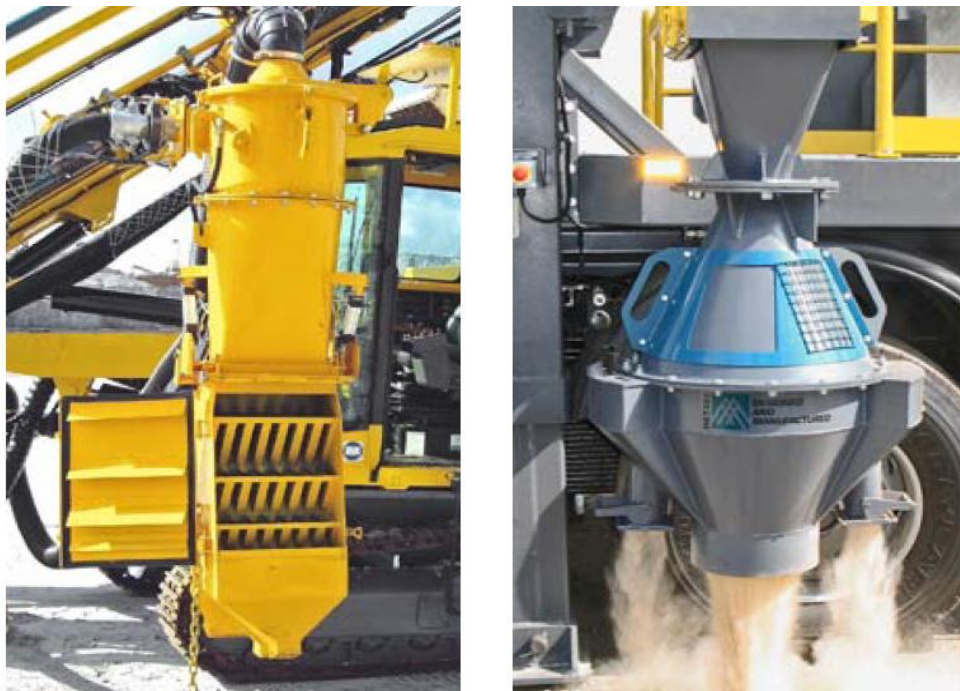
Figura 26. a) Cuarteador tipo riffle. b) Cuarteador tipo cono.
