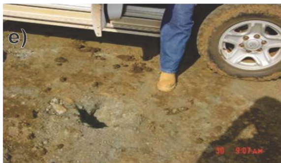
Figura 27. Algunos riesgos de la mina a cielo abierto. a) Desplome de cresta del talud. b) Proyección de partículas por detonación de voladura. c) Colisión de vehículos y equipos. d) Accidentes por fatiga laboral. e) atrapamiento de pies en barrenos o pozos. f) Caídas en escaleras al bajar o subir a un equipo.
