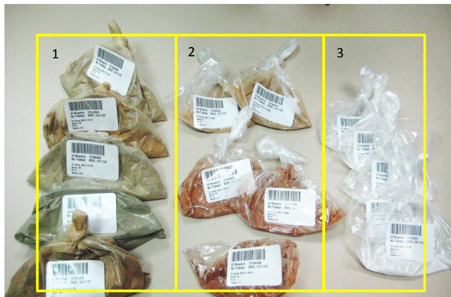
Figura 49. Muestras de control preparadas por el geólogo para llevarlas al laboratorio diariamente. 1. Pulverizados para re-análisis. 2. CRM de distintas leyes de níquel. 3. Blancos finos. Los blancos gruesos se preparan en el laboratorio.
