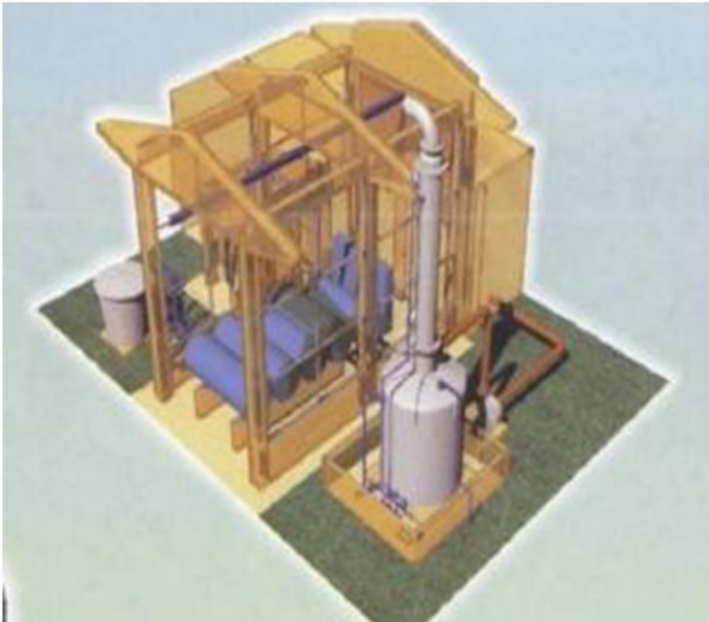
Figura 16. Caseta de cloro con adsorción de cloro con alúmina.
