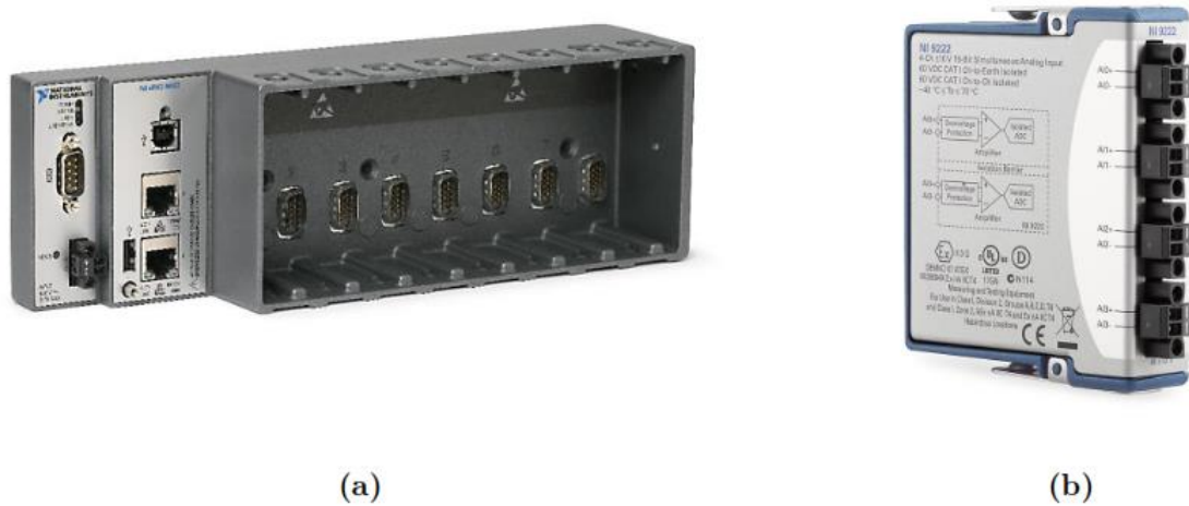
Figura 27. Sistema de adquisición de datos adquirido a NI (National Instruments). (a) Sistema CompactRio9067, (b) módulo 9223 con cuatro entradas de señal
