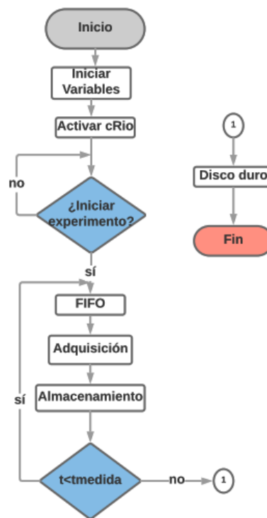
Figura 31. Diagrama de bloques para la adquisición de datos con el sistema cRio9067 y el módulo 9223.
