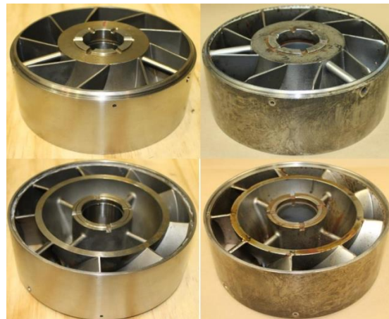
Figura 70 Prueba de remoción de pintura. Comparación de difusores, antes de prueba (izquierda) y después (derecha). (Chen, 2017)
