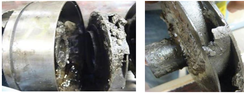
Figura 22 Difusor (derecha) e Impulsor (izquierda) mostrando signos de acumulación de arena y erosión de los álabes. (Bonilla y Chen, 2019)
