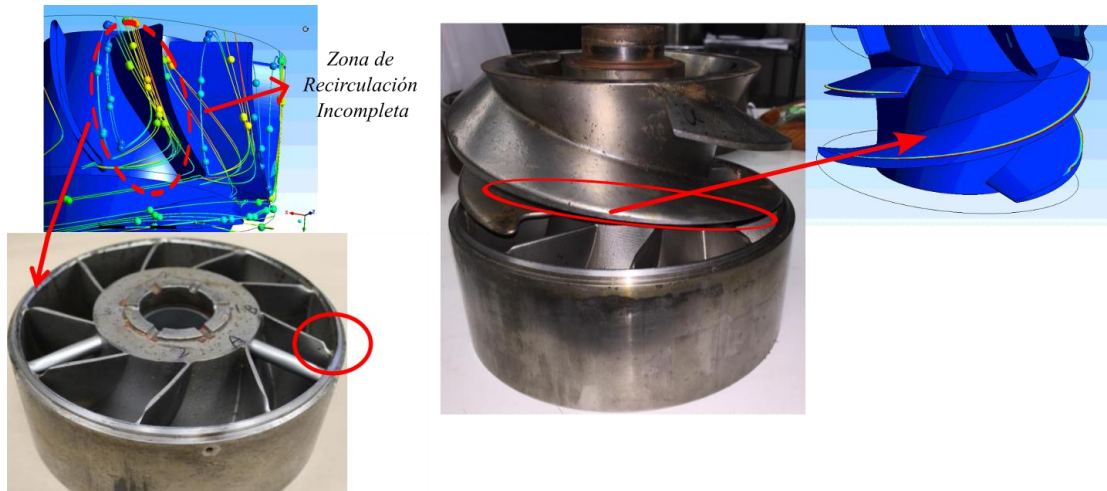
Figura 71 Validación de resultados, simulación de flujo con arrastre de partículas versus ensayos experimentales. (Chen, 2017)
