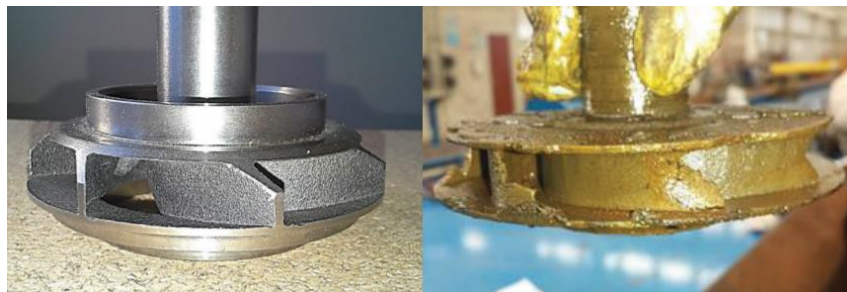
Figura 23 Impulsor nuevo (izquierda) e impulsor erosionado (derecha). (Bonilla y Chen, 2019)
