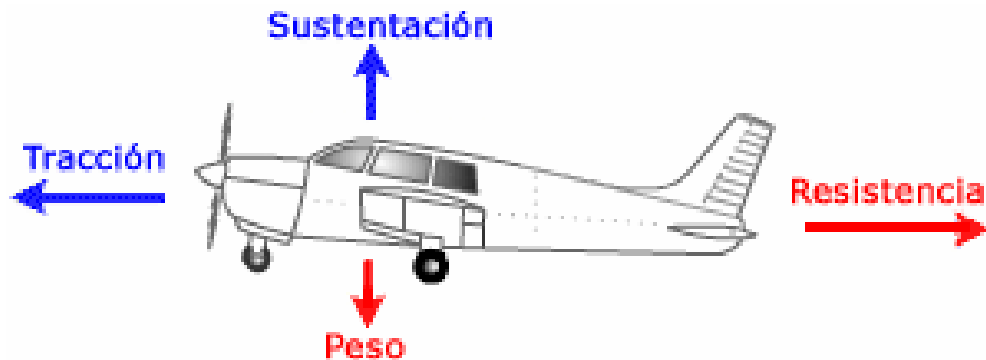
Figura 95. Fuerzas que actúan en vuelo
