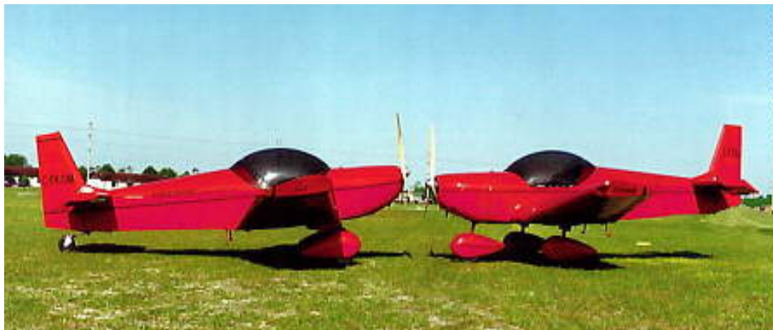
Figura 11. Aviones ultralivianos con tren patín de cola y tren tipo triciclo
