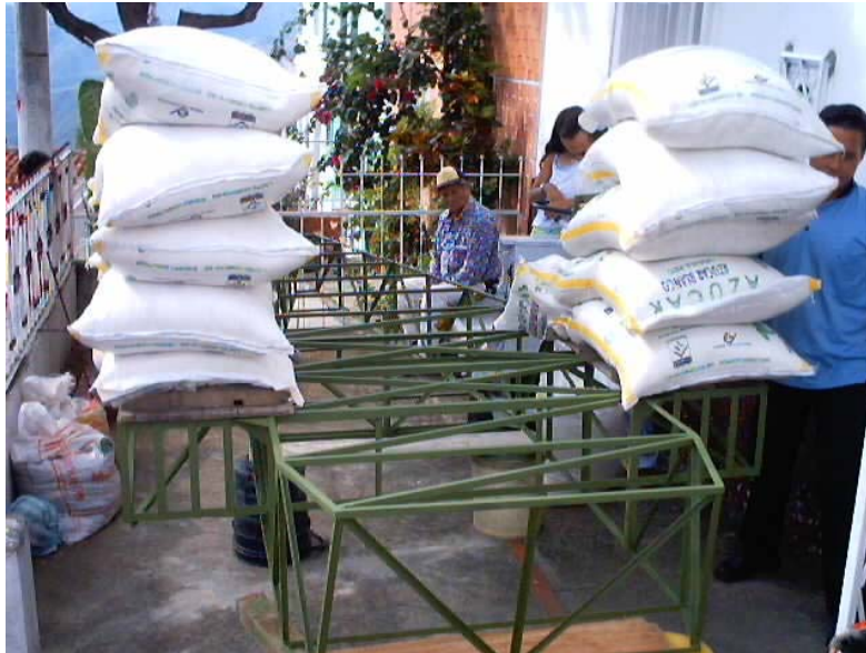
Figura 77. Prueba de Carga
