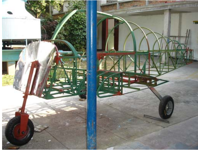
Figura 82. Detalle de fuselaje y tren
