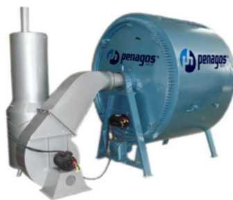
Figura 2. Equipo utilizado para secar café tipo bombo o Guardiola
