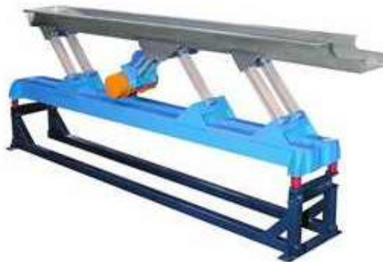
Figura 22. Transportador vibratorio electromagnético utilizado en la industria alimenticia.
