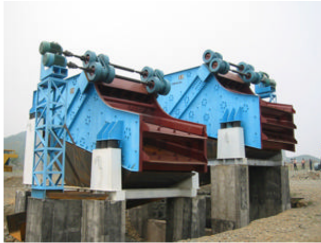
Figura 24. Clasificadoras vibratorias montadas en serie para la clasificación de arena.
