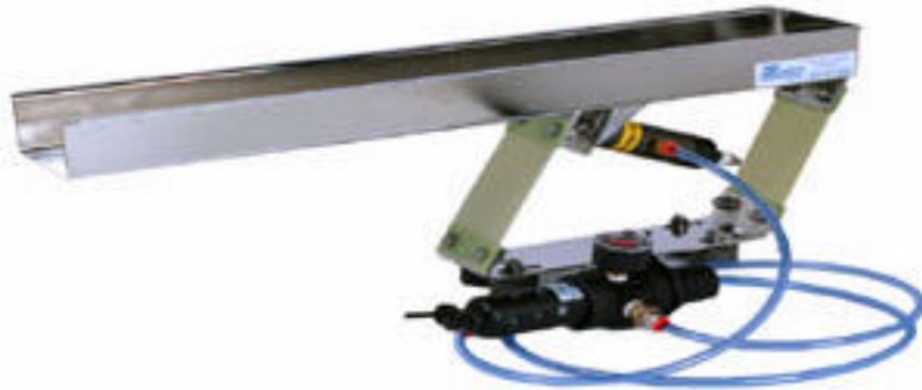
Figura 21. Transportador vibratorio neumático para productos alimenticios.
