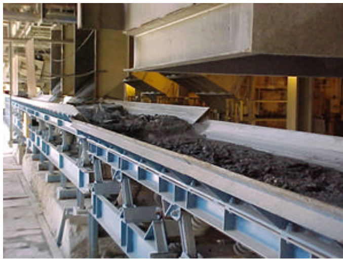
Figura 23. Transportador vibratorio mecánico para la conducción de carbón.
