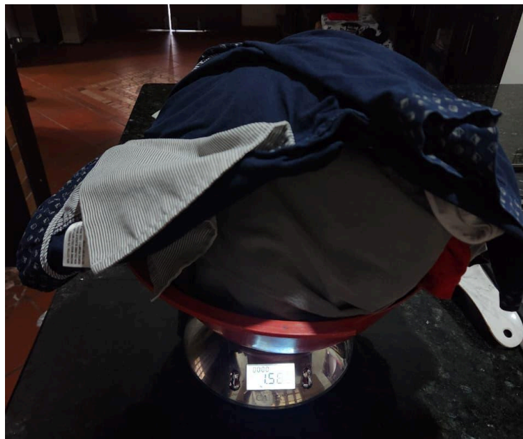
Pesaje segunda prueba de secado tras 1 hora en la secadora
