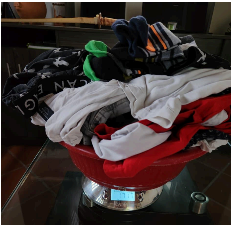
Pesaje cuarta prueba de secado tras 1 hora en la secadora
