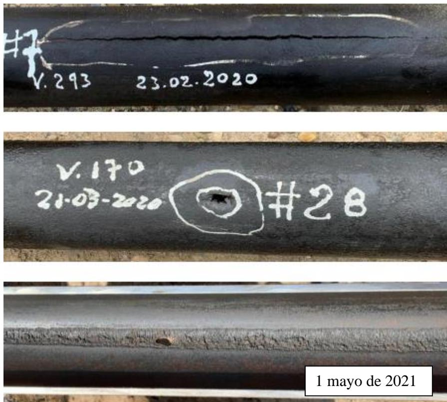
*Nota.* Tubería rota saliente de un pozo en el campo estudio. Foto tomada por el autor.
