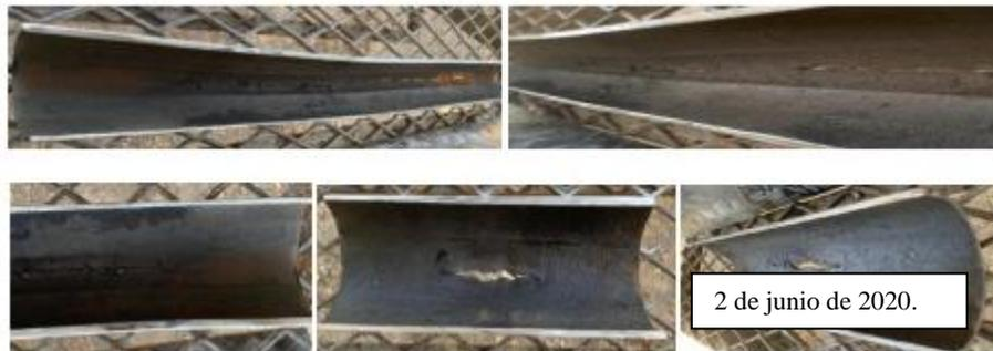
*Nota.* Tubería rota saliente del pozo 3, foto tomada por el autor.
