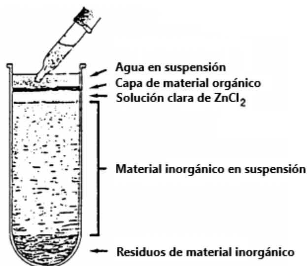
Figura 1. Técnica de flotación con Cloruro de Zinc, tomado y modificado de Traverse (2007)
