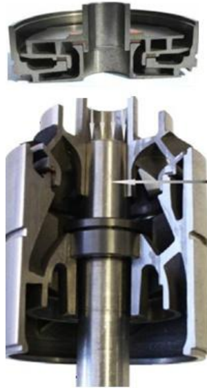
Figura 6. Foto de etapas de tipo radial y mixto.
