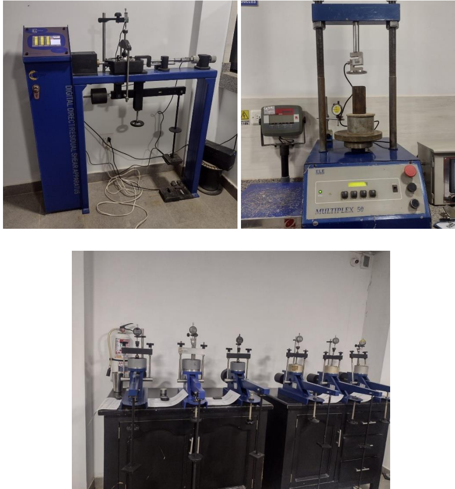
Figura 1. Ensayo de corte directo, compresión inconfiada y consolidación realizados en el laboratorio. Fuente: SECOIN S.A.S.
