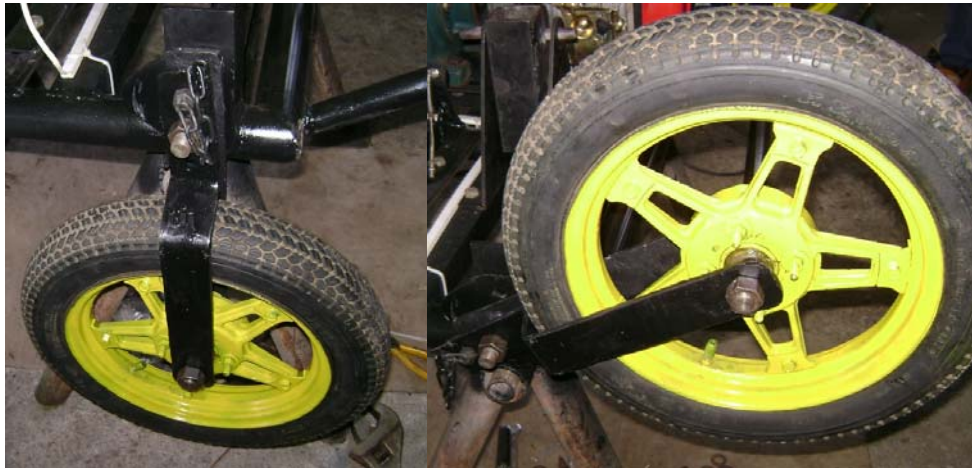
Figura 32. Apoyo y posiciones de las ruedas del trineo [4]
