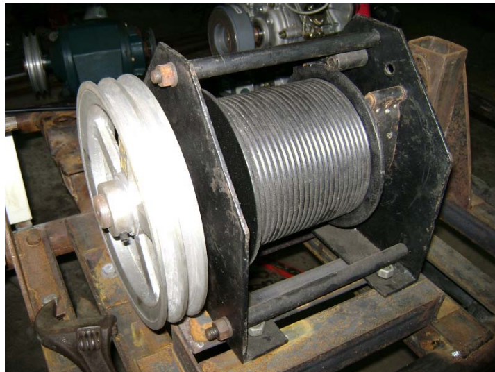
Figura 33. Apoyos del malacate con sus respectivas correderas [4]
