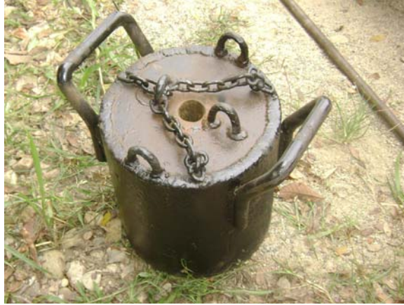
Figura10. Bloque o Porro utilizado para el pilotaje [4]
