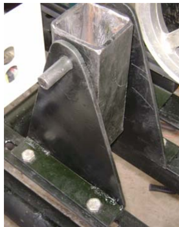
Figura 35. Unión entre el trípode y el bastidor mediante un acople cuadrado [4]
