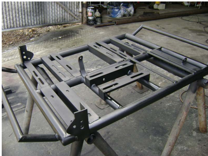
Figura 31. Bastidor con sus puntos de ubicación para los elementos de la máquina [4]
