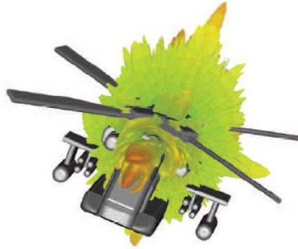
FIGURA 0-3: Simulación del campo electromagnético, (Far-field) de una antena en un helicóptero. Aplicación militar.
