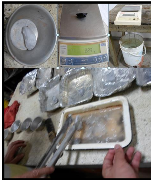
Figura 81. Calculo de densidad según Normas ASTM E-145 y ASTM 2216-98.
