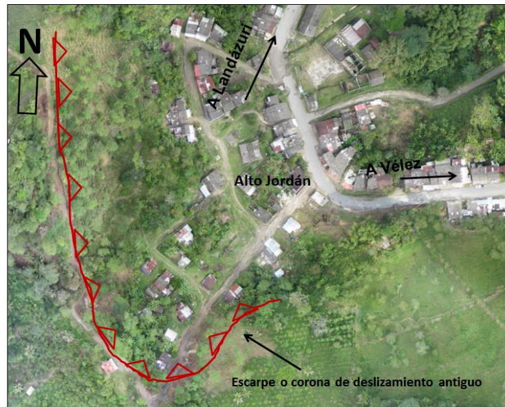
Figura 56. Escarpe o corona de deslizamiento antiguo al Sur-Oeste del área de estudio.
