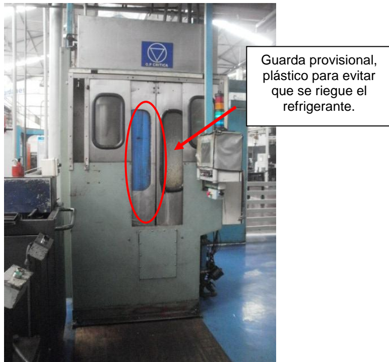
Figura 66. Vista general del encerramiento de la Tocco II.
