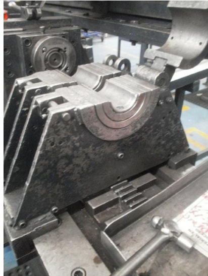
Figura 5. Guarda manual con problemas de diseño.
