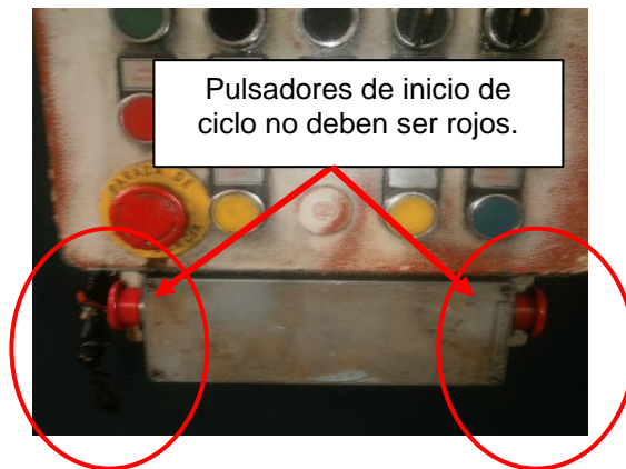
Figura 67. Doble pulsador de inicio de ciclo
