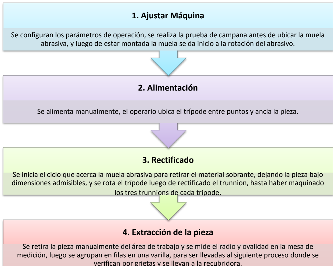
Figura 122. Funcionamiento de la rectificadora por etapas.
