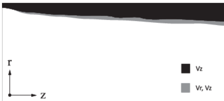
Figura 91 Forma del depósito para un caudal de 1 gpm y una temperatura de pared 7.2°C ( t = 5 días)
