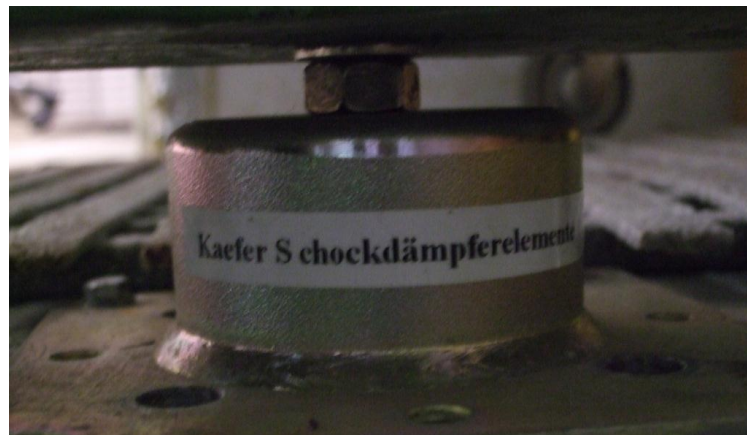
Figura 6. Elementos Amortiguadores Del Banco De Prueba De Motores, Hocshule Bremen University of Applied Sciences
