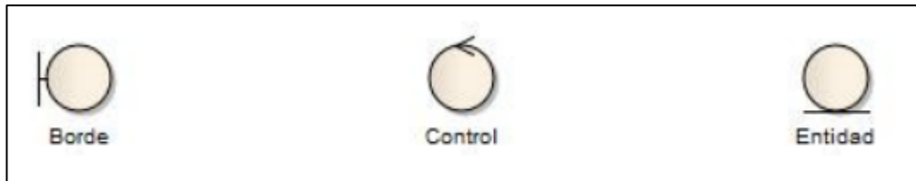
Figura 89. Elementos utilizados en el patrón MVC.
