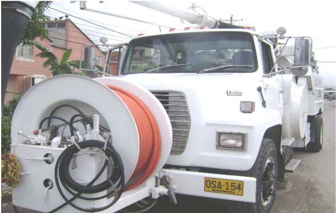
Figura 5 Equipo de análisis y limpieza del alcantarillado. Vector
