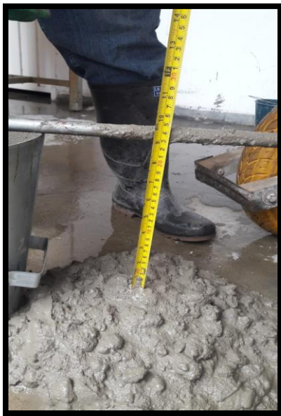
Slump patrón : 10 pulgadas
