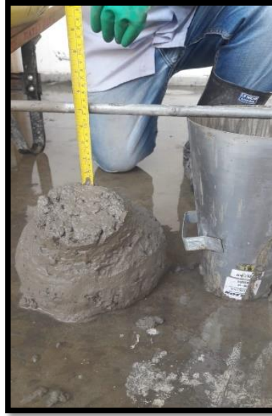
Slump con 20% CCA: 5.6 pulgadas con adición de 1000 mililitros
