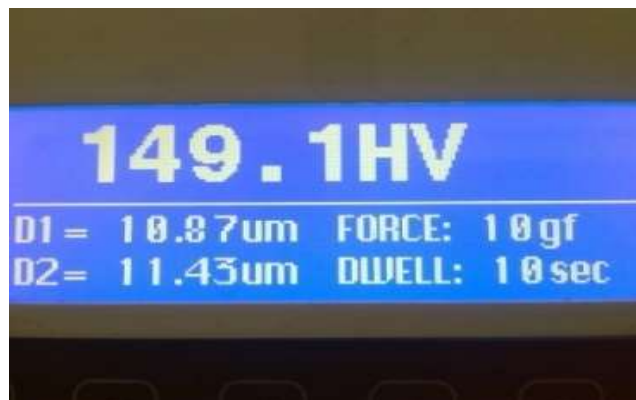
Figura 13. Resultado de la medición de una huella de microdureza Vickers del Aluminio en equipo de microdureza INNOVATEST423D.
