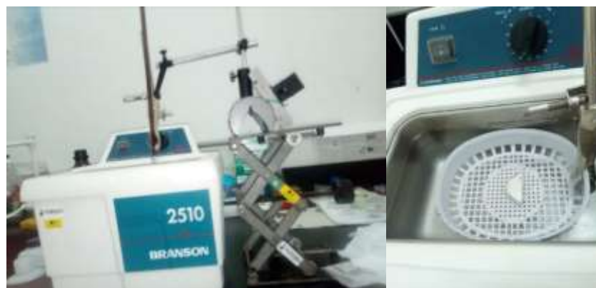
Figura 16. Montaje experimental de las muestras en el limpiador de ultrasonido
