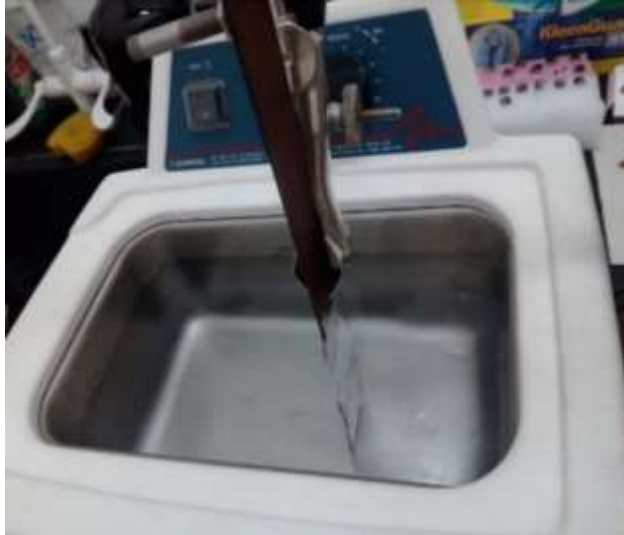
Figura 14. Esquema de posicionamiento del papel aluminio en cubeta de ultrasonido
