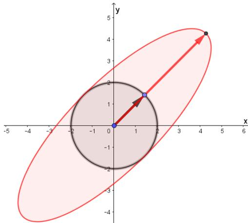
Figura 24: Transformación de un círculo bajo la matriz  $B$
