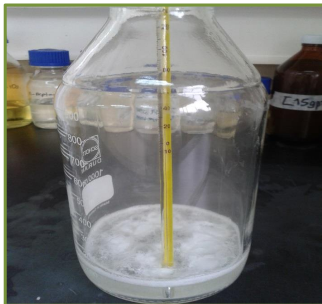
Figura 29. Ocurrencia de la reacción y toma de temperatura.
