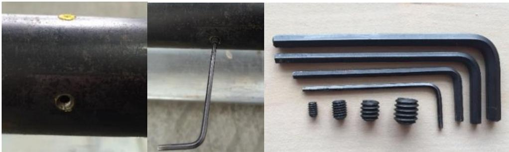
*Figura 24* Fugas y accesorios para su taponamiento
