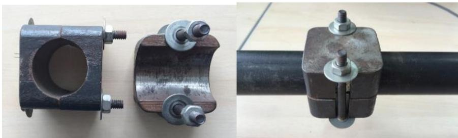
Figura 23 Accesorio tipo clamp para la agregación de masas en tuberías de una pulgada
