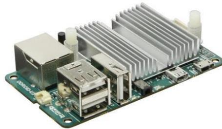
Figura 13 Plataforma Embebida Odroid U3
