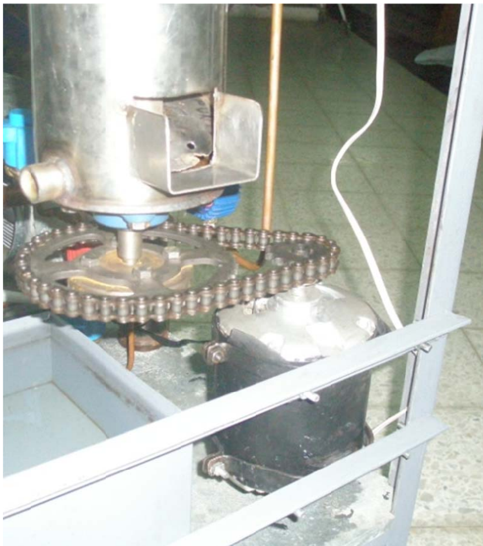
Figura 96. Instalación del sistema de corte.
