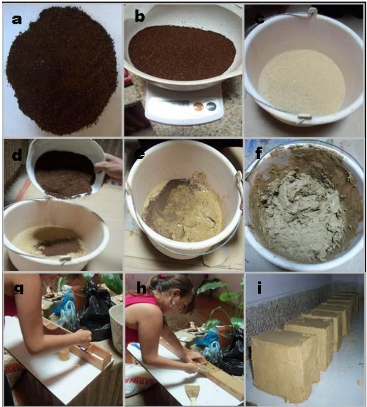
Figura 11. Procedimiento en la realización de materiales cerámicos (Ladrillos): a. Muestra de Cacota de Cacao, b. Peso del residuo a incorporar, c. Materia Prima cantidad a utilizar, d. Incorporando La Cacota de Cacao en la Materia Prima, e. Adicionando agua a la mezcla, f. Mezcla general para el ladrillo, g. Se coloca un aislante (en este caso ACPM) para que el Ladrillo no se adhiriera a las paredes h. Con una espátula rellenando el molde para realizar los ladrillos, i. Ladrillo final con la adición correspondiente. Fuente: Autor
