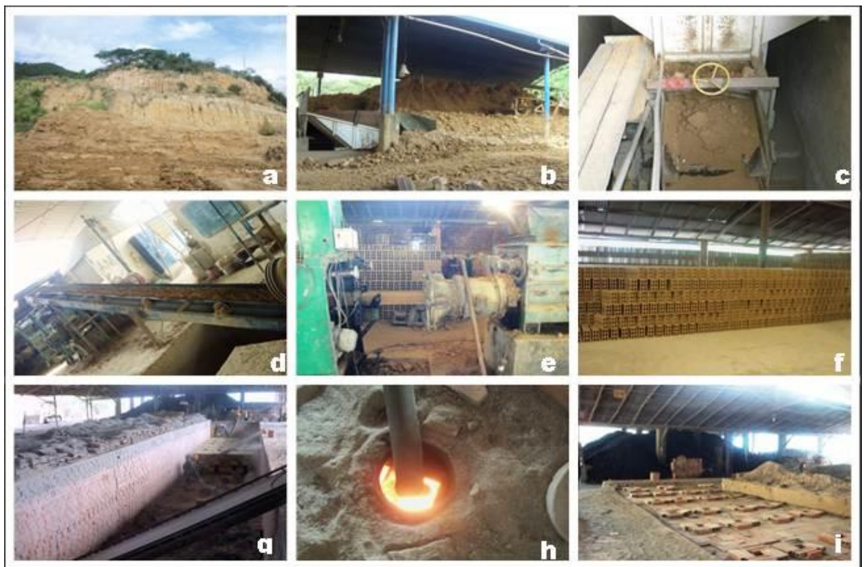
Figura 4. Ladrillera ERGO Durán y García Ltda. (a) Frente de explotación de materia prima. (b) Proceso de selección de mezcla. (c) Tolva que separa el material. (d) Proceso de producción de extendido. (e) Máquina extrusora. (f) Proceso de encasillado.
