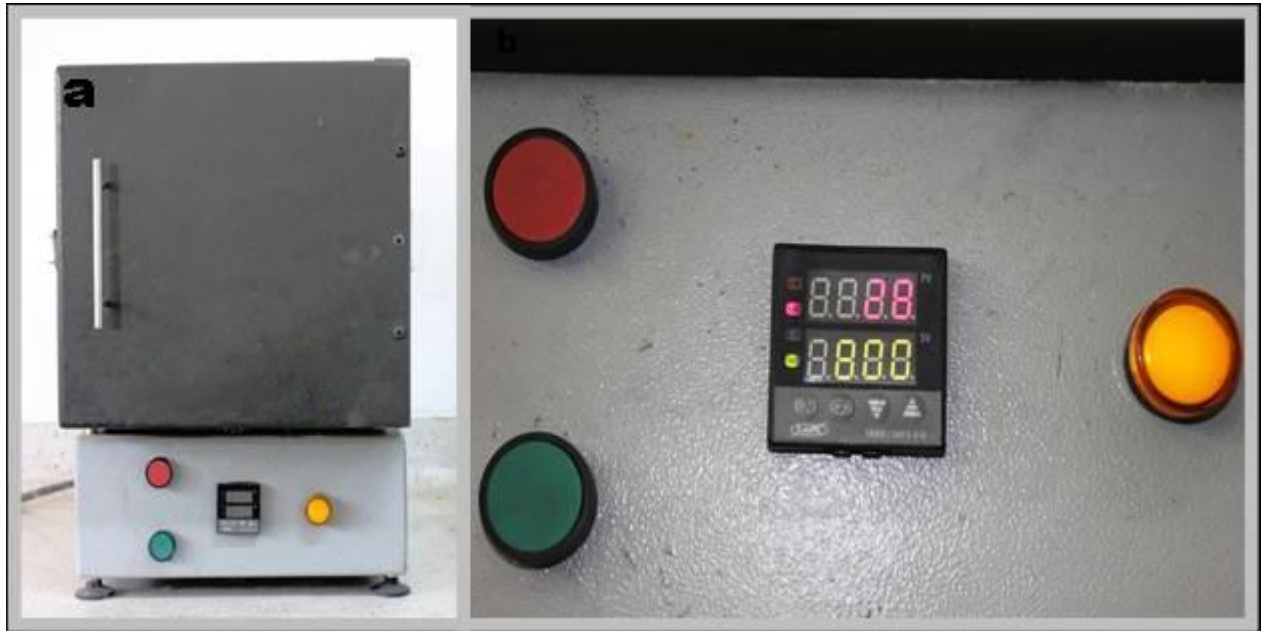
Figura 12. A. Mufla de calcinación. B. Se observan el PV y el SV.
