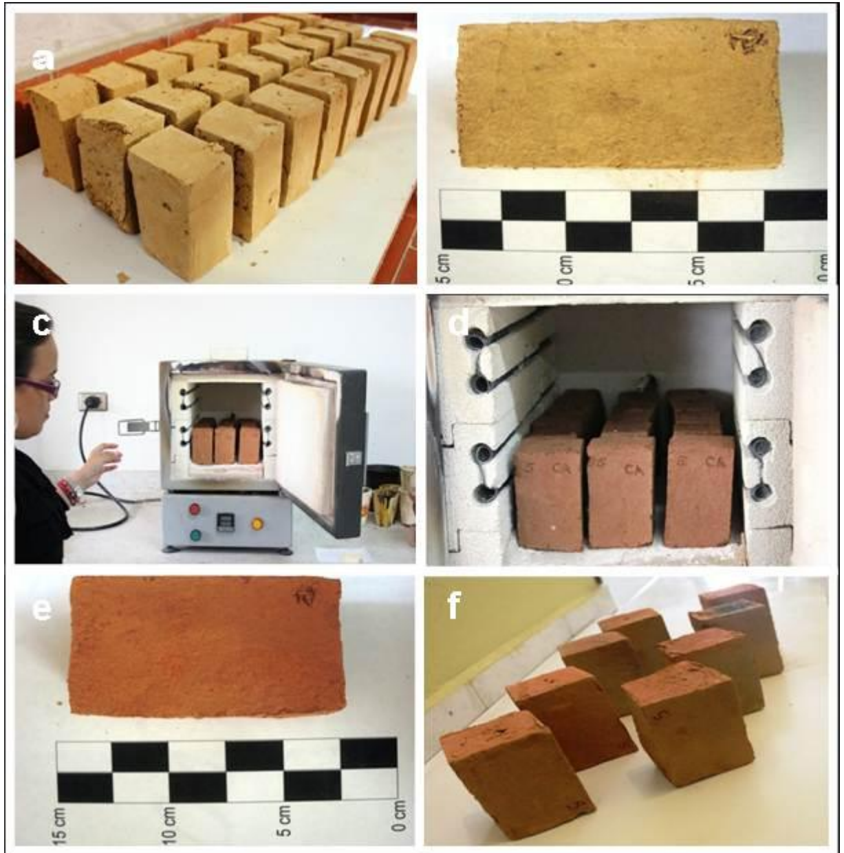
Figura 13. A. Ladrillos Crudos, B. Dimensiones de los Ladrillos antes de ser calcinados, C. Mufla de Calcinación, D. Ladrillos después de ser calcinados y de haber reposado, E. Dimensiones de los Ladrillos después de calcinados y F. Ladrillos Calcinados. Fuente: Autor
