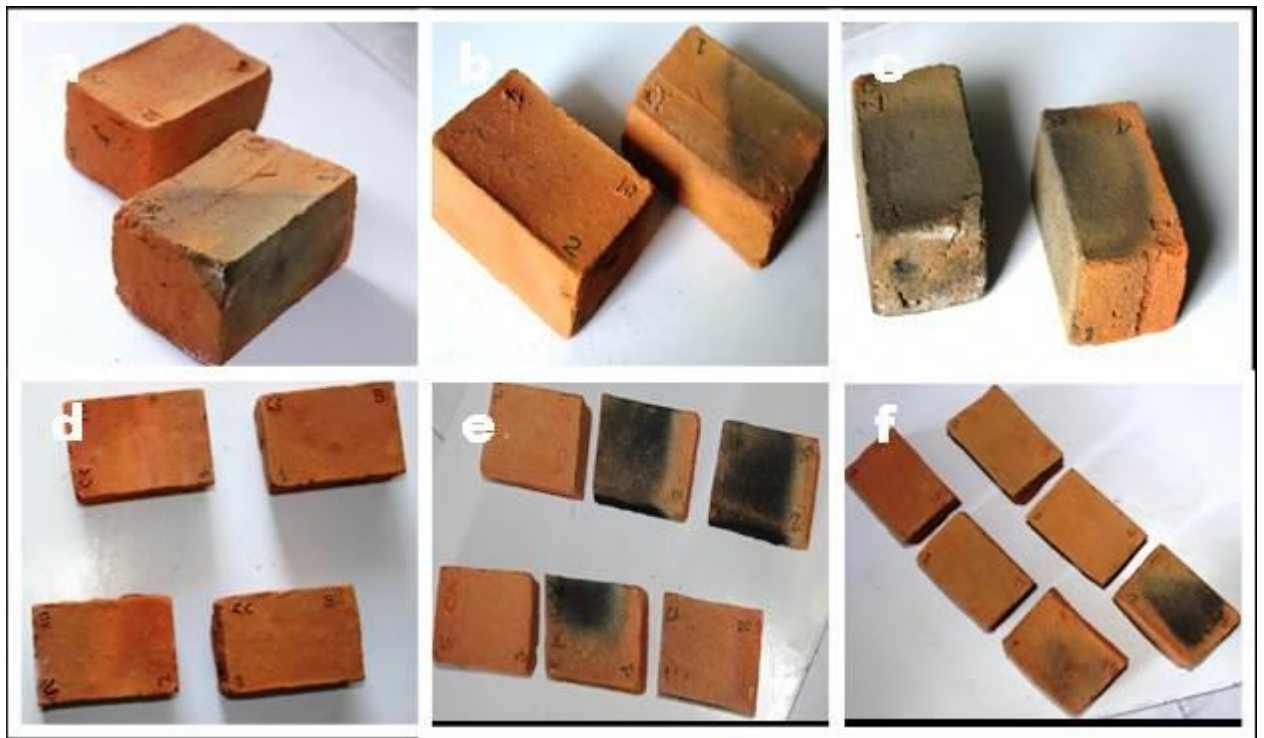
Figura 21. Lote de ladrillos utilizados para los ensayos de soluciones en ácido. A. Ladrillos con aditivo de aserrín 5%, B. Ladrillo con aditivo de aserrín de 10%, C. Ladrillos con aditivo de aserrín de 40%, D. Lote ladrillos aditivo de cacota de cacao, E. Lote de
