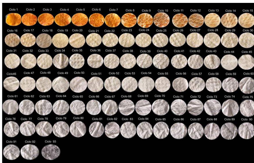
Figura 25 Superficie de celulosa y polipropileno en los test de degradación de índigo carmín..
