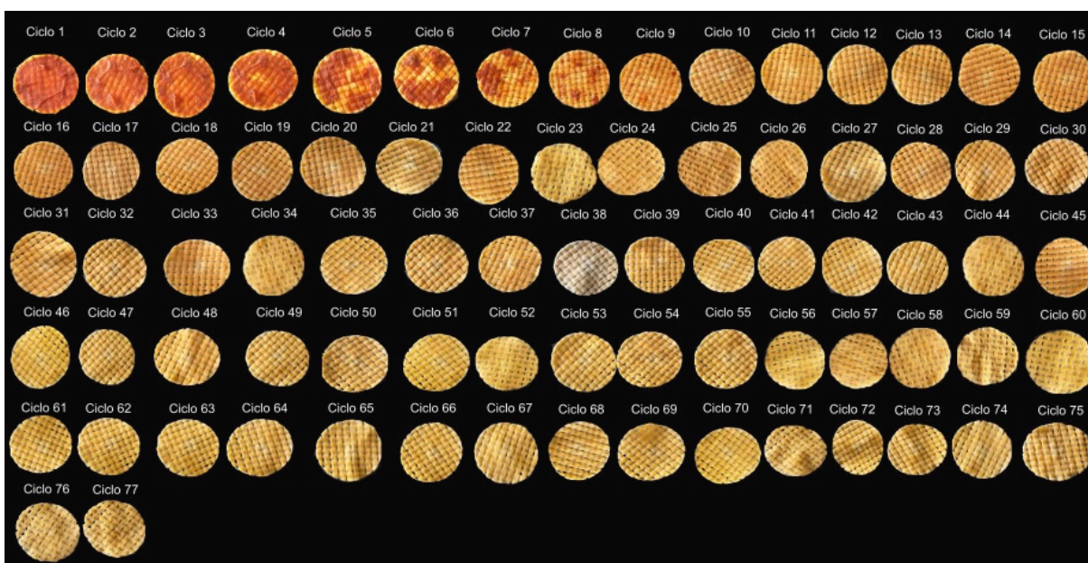
Figura 19 Superficie de celulosa y poliéster en los test de degradación de índigo carmín.
