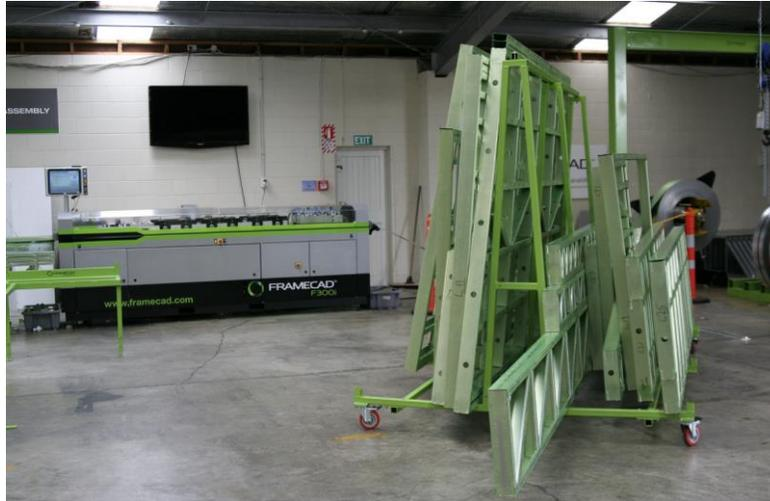
*Figura 71.* Almacenamiento de paneles ensamblados (FRAMECAD)
