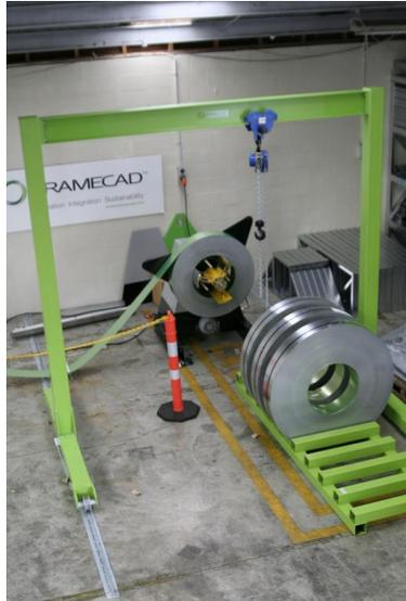
*Figura 59.* Bobinas listas para proceso de laminado (FRAMECAD)
