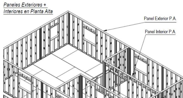
*Figura 84.* Montaje de muros del segundo piso
