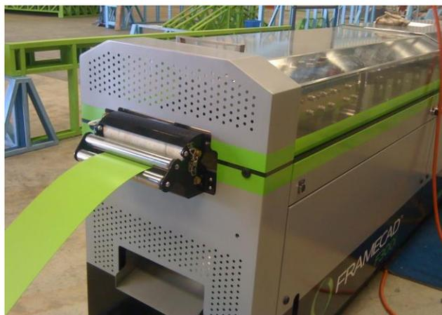
*Figura 60.* Alimentación de la bobina para el inicio del laminado
