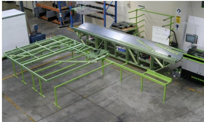
Figura 61. Mesa receptora de perfiles y mesa de ensamblaje
