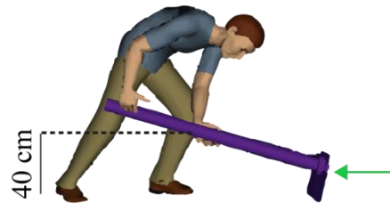
Figura 34. Simulación del agricultor en el momento del arrastre mediante la plataforma Jack siemens
