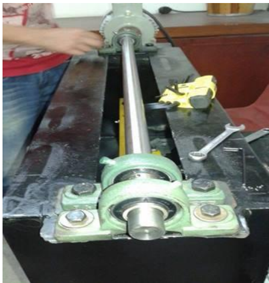
Figura 47. Barra de acero para alinear chumaceras.
