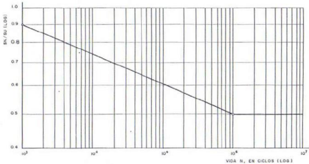
Figura 7. Curva S-N generalizada para acero forjado.
