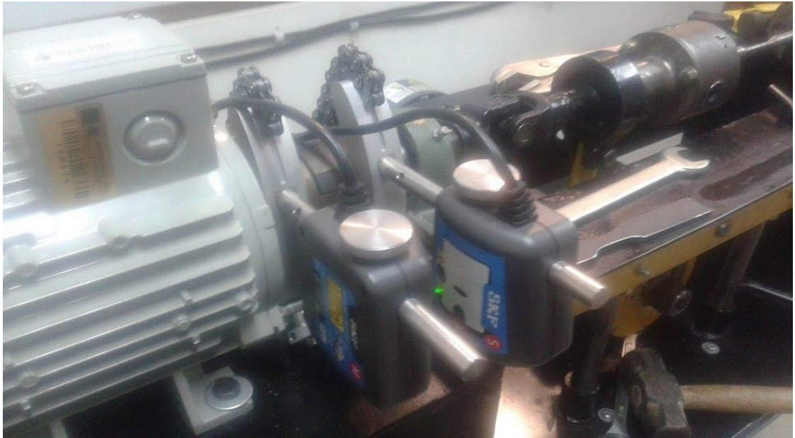
Figura 46 . Equipo de alineamiento de ejes montado en la máquina.
