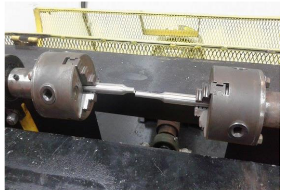
Figura 57. Probeta cilíndrica que ha fallado por fatiga.
