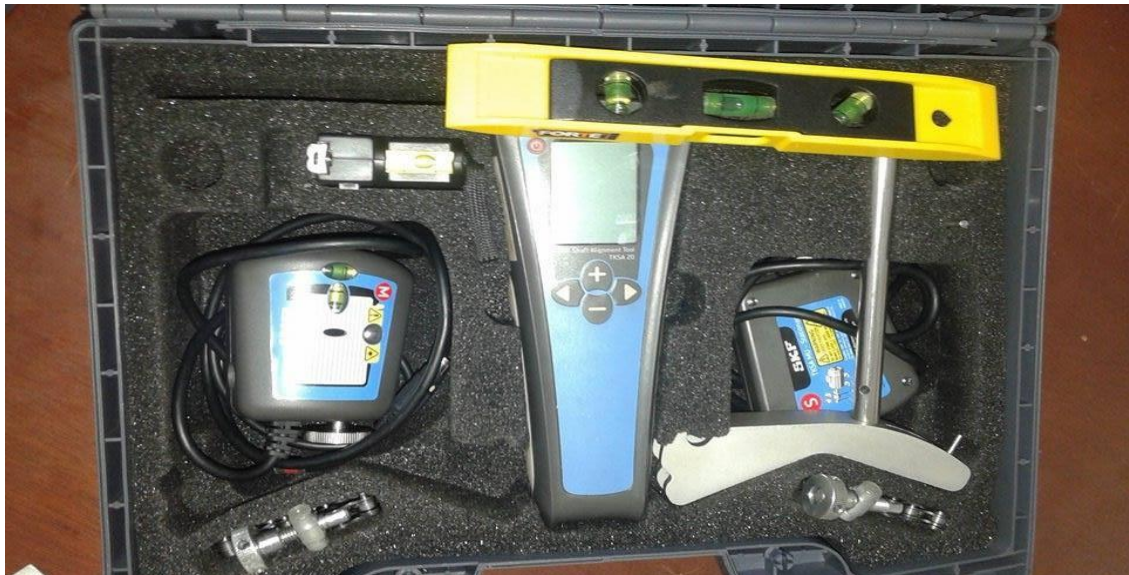
Figura 45. Equipo de alineamiento de ejes.
