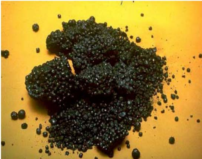
Figura 2. Fotografía de una muestra de coque perdigón (Elliot 2000)
