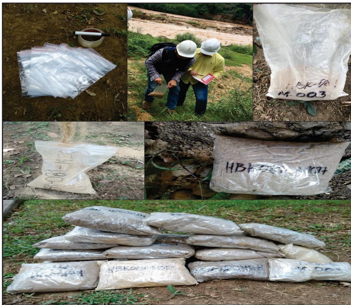
Figura 52. Método de recolecciones de muestra; materiales necesarios, toma de muestra, empaquetamiento y sellado.
