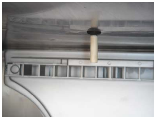
Figura 39. Ubicación del sensor S_{air} dentro del banco experimental
