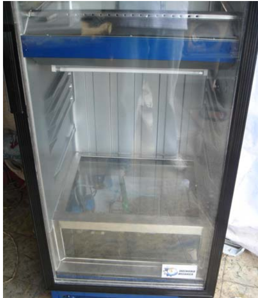
Figura 11 Cámara de refrigeración del mueble
