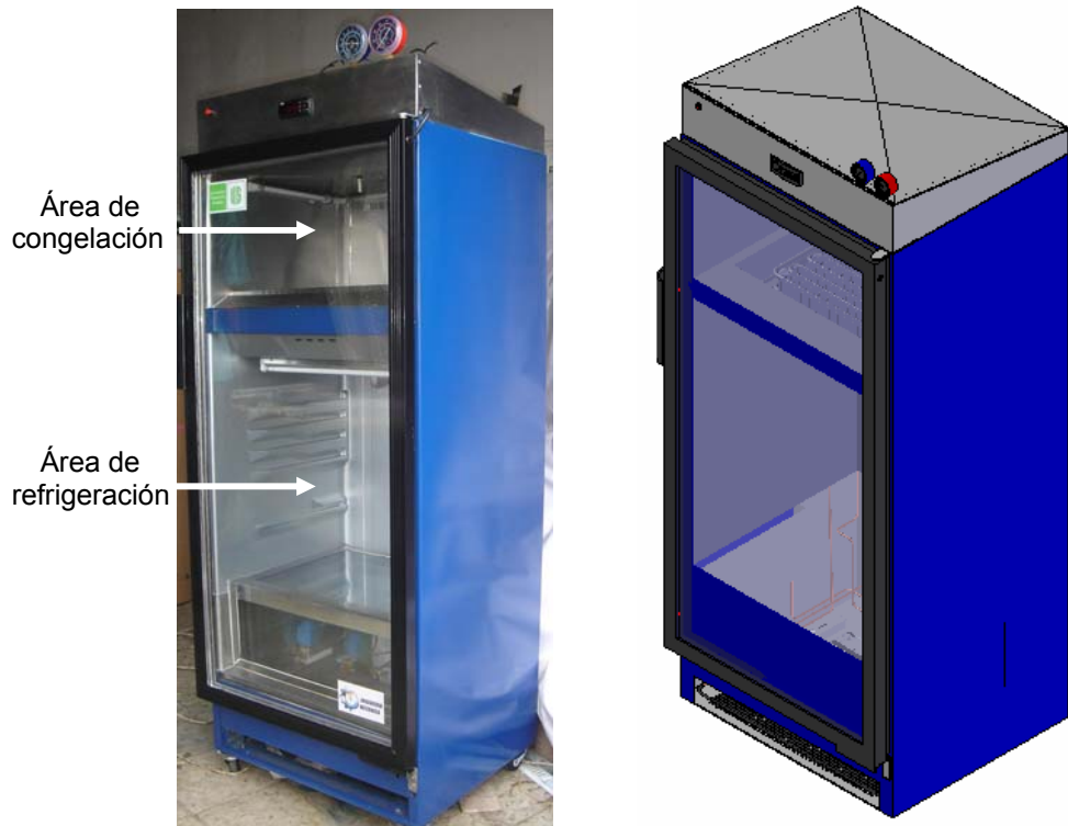
Figura 9. Banco de pruebas experimental para el control de diferentes tipos de descongelamiento.
