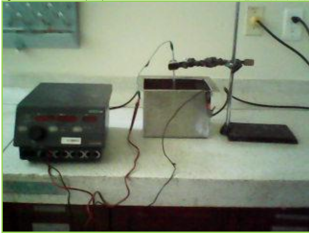
Figura 4. Montaje de la celda de electropulido a nivel de laboratorio, en las instalaciones del Grupo de Investigación en Corrosión (GIC).
