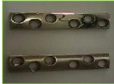
Figura 11. Placas DCP de acero inoxidable 316 LVM electropulida con las variables estandarizadas y no electropulida.
