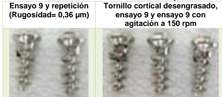
Figura 7. Tornillos corticales de acero inoxidable 316 LVM del ensayo 9 del Anexo B.
