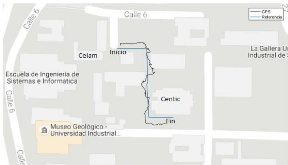
Figura 14. Señal del GPS obtenida en una caminata de manera offline.
