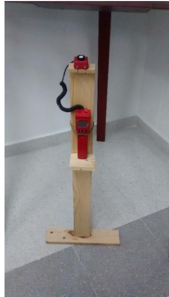
Figura 35. Medidas con Luxómetro a la altura del nivel de trabajo
