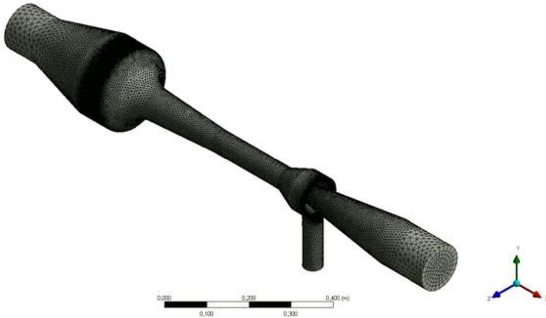
*Figura 10.* Vista isométrica de la malla obtenida con las configuraciones de la tabla 6.
