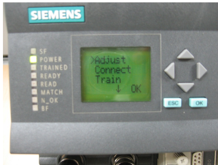
Figura 15. Panel de configuración de la unidad de evaluación Referencia Fotográfica
