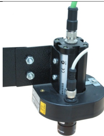
Figura 6. Cabezal del sensor de Visión SIMATIC VS 130-2 Referencia Siemens VS130-2_Handbunch
