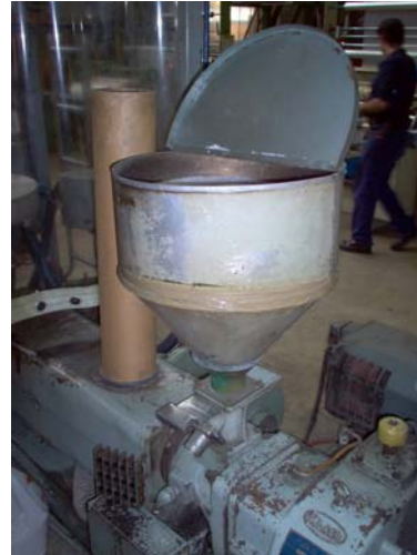
Figura 8. Tolvas de Alimentación Automática y Manual Respectivamente
