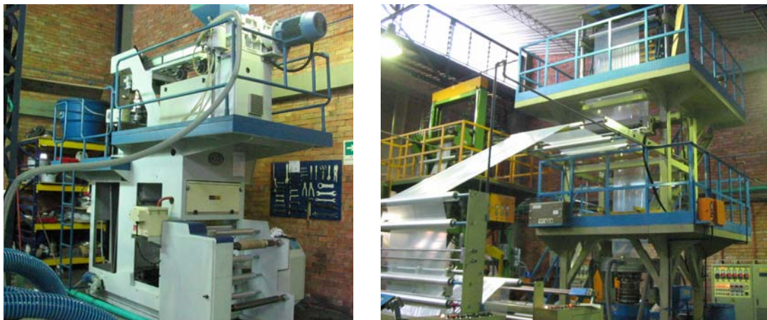
Figura 6. Extrusoras Master 50 para Polipropileno y Extrusora 55 para Polietileno de Alta y Baja Densidad
