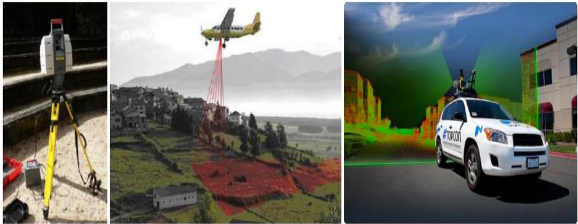
Figura 8 Imagen izquierda, un escáner láser terrestre de la marca Leica . En la imagen del centro, visión explicativa de un escaneo aéreo. A la derecha, un sistema de mobile mapping .
