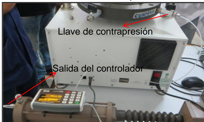
Figura 60. Conexión entre el controlador y la llave de contrapresión.
