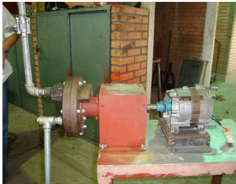
Figura 71. Ensamble de la turbina, caja de rodamientos y generador eléctrico
