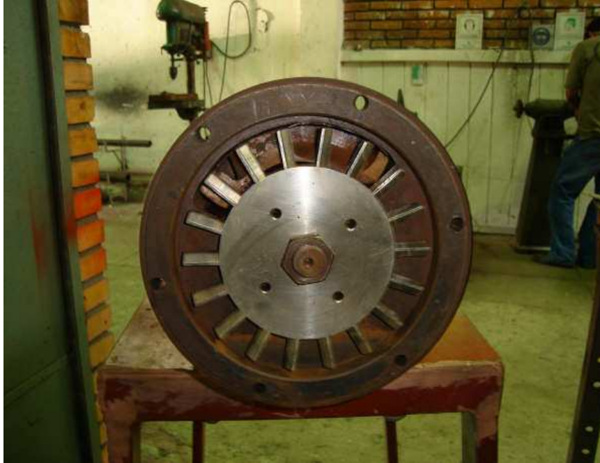
Figura 69 Tapa posterior y rodete de la turbina de acción a vapor.
