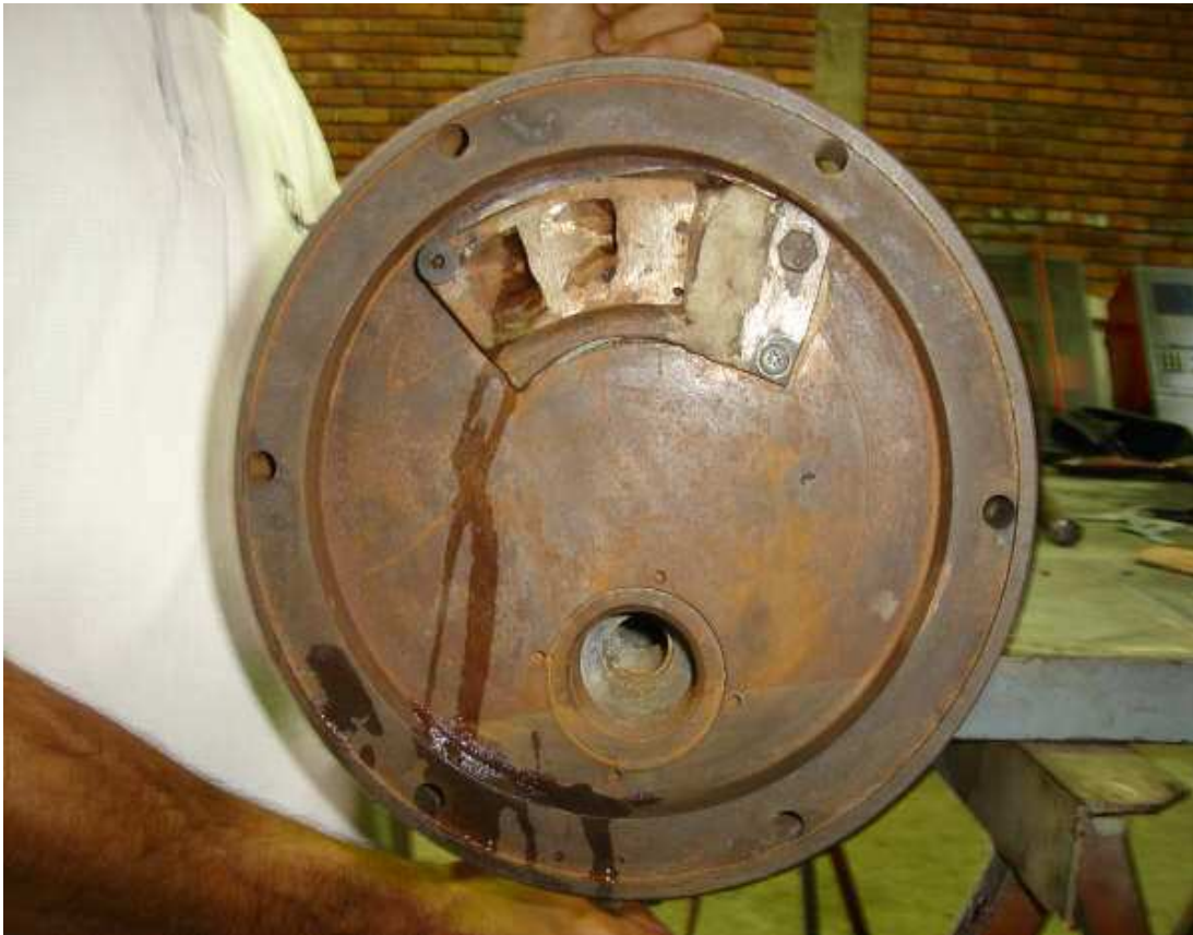
Figura 58. Tapa frontal y tobera de entrada de la turbina.
