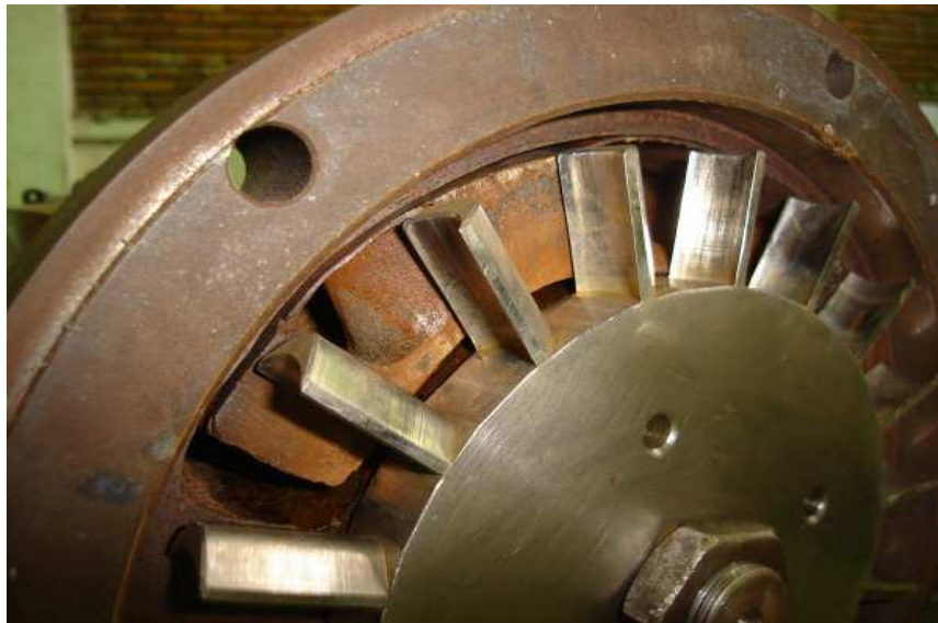
Figura 70. Tapa posterior, rodete y disposición de la cámara reversible alojando la tobera de retorno de flujo de la turbina de acción de vapor.
