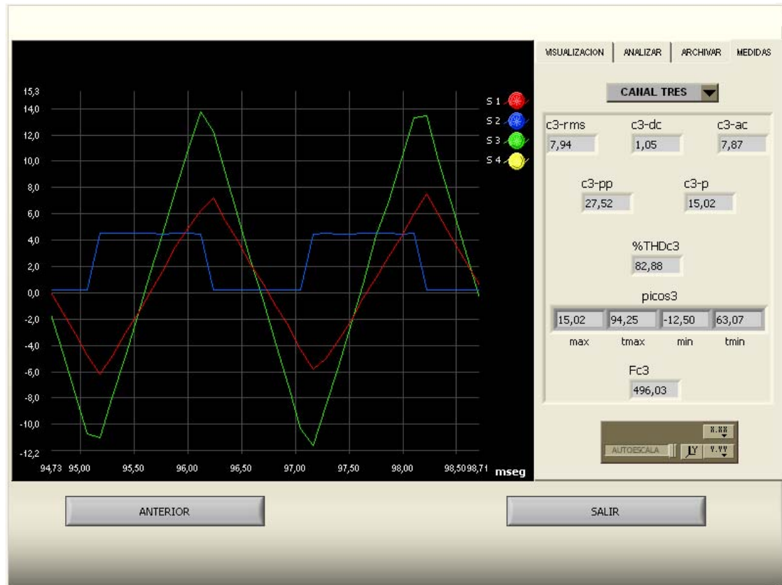
Figura 38. Adquisición de tres señales: una cuadrada y dos triangulares
