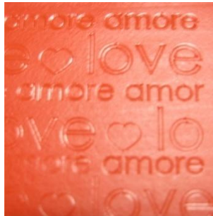
Figura 17. Grabado sobre una pieza de PVC.
