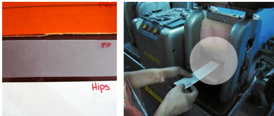
Figura 19. Muestras y ensayo de elongación.
