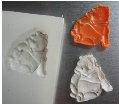
Figura 14. Estampado en lamina de PVC, Foam Board y PS
