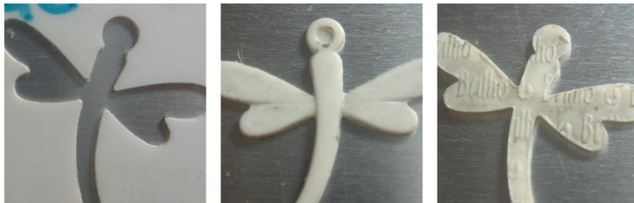
Figura 15. Pasos para el proceso de acuñado en lámina de poliestireno.
