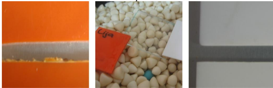
Figura 16. Acabado superficial de las probetas de PVC y PS después de proceso en maquina de lija.
