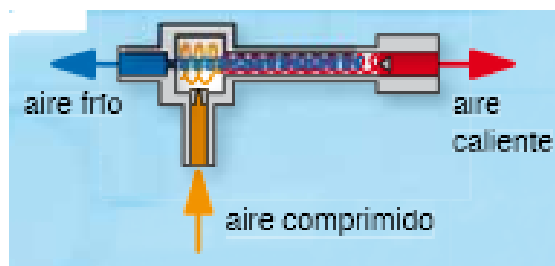
Figura 15. Generador de Frío Vortex
