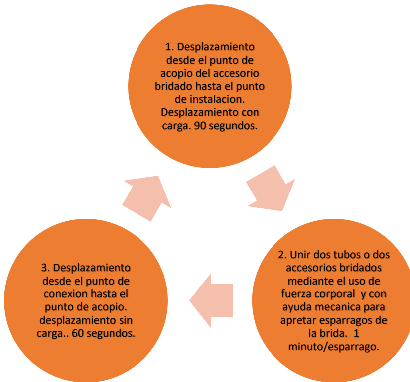
Figura 19. Proceso para ajustar una unión bridada.
