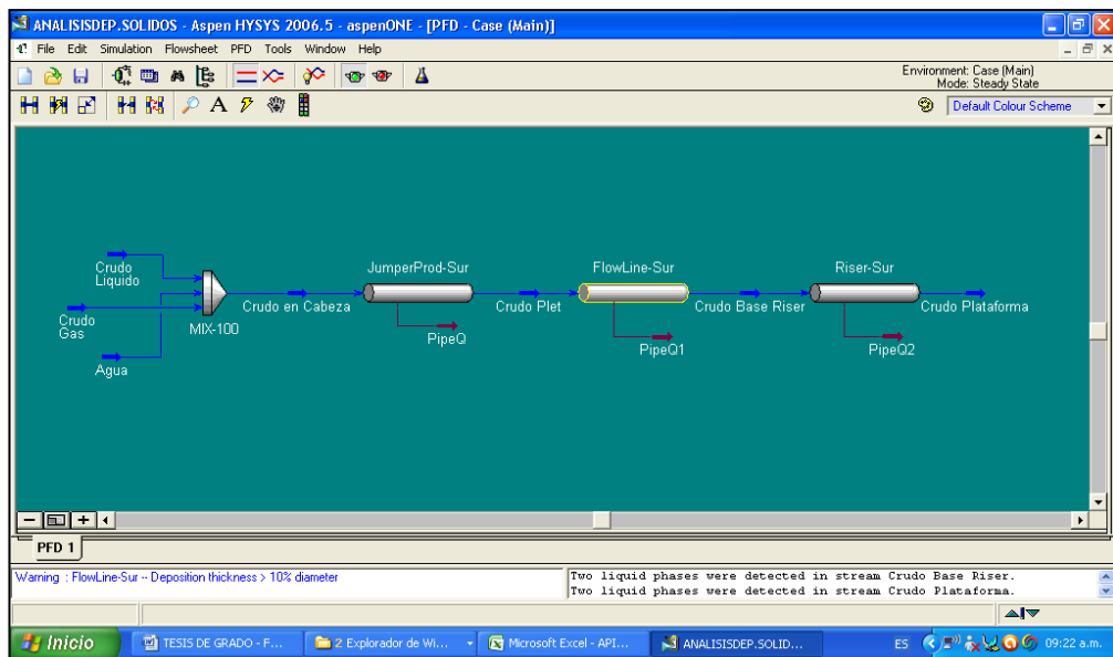
Figura 7.41. Sistema submarino de producción en el ambiente de simulación de HYSYS después de corrida la simulación: Líneas Sur.
