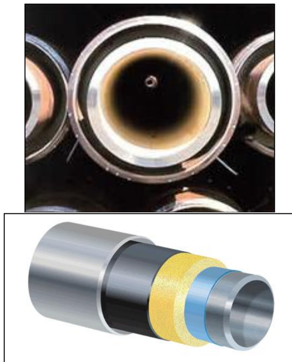
Figura 3.6. Esquematación de las tuberías pipe-in-pipe.
