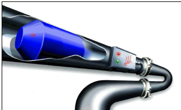
Figura 2.23. Ilustración del recorrido de un marrano por el interior de la tubería.
