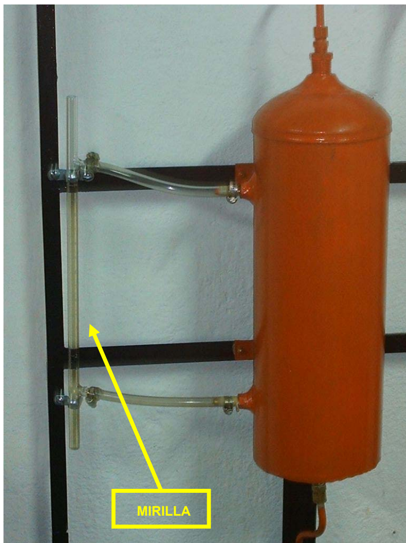
Figura D5. Tanque Aforado con escala
