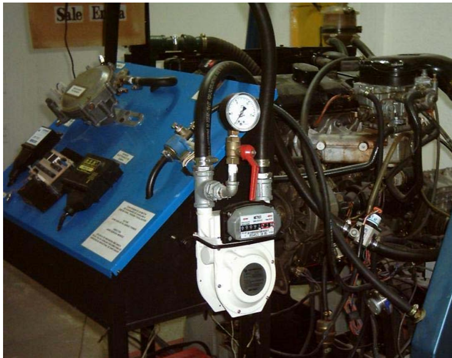
Figura 42. Banco de Conversión de Gasolina a Gas Natural
