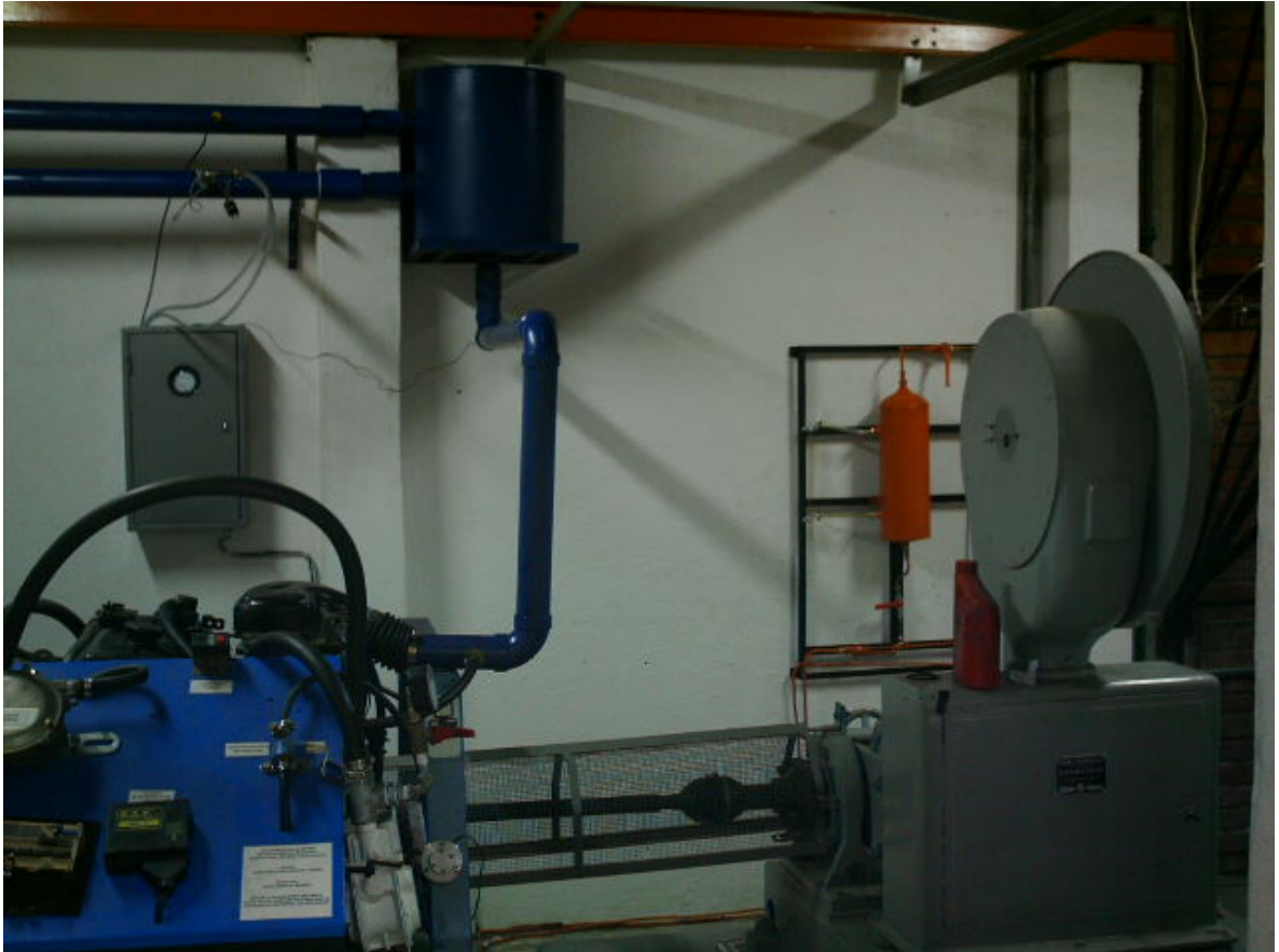
Figura D1. Sistema de medición de la Relación Aire - Combustible
