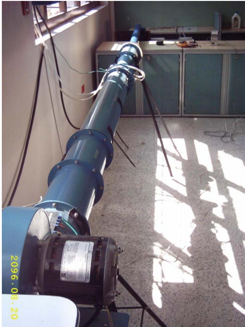
Figura 18. Banco de medición de flujo de gases.
