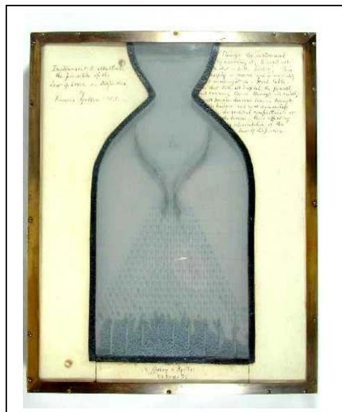
Figura 2.1 Primera Máquina de Galton construida en 1872.
